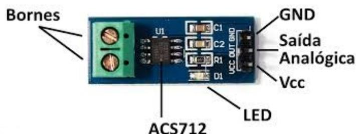
**Figura 4.4: Descrição de pinos do sensor de corrente ACS712. Fonte: [10]**
