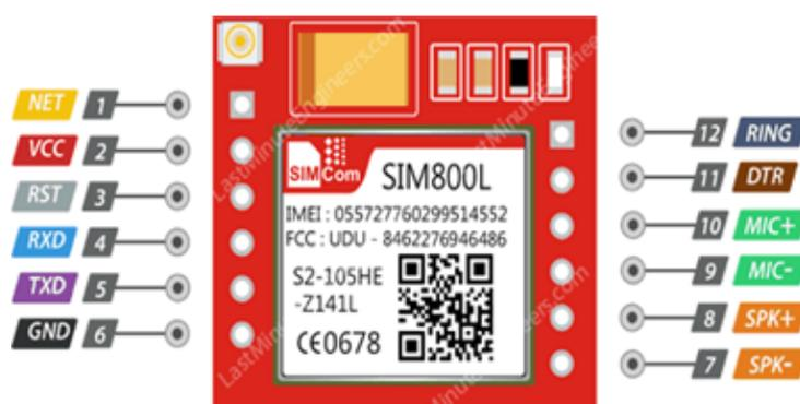
**Figura 4.6: Descrição de pinos do módulo SIM800L. Fonte: [12]**
