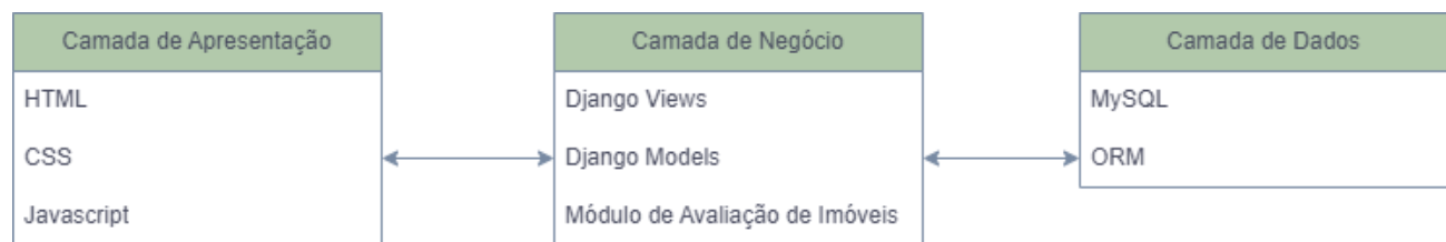
Figura 10 - Diagrama da arquitectura em 3 camadas da aplicação
