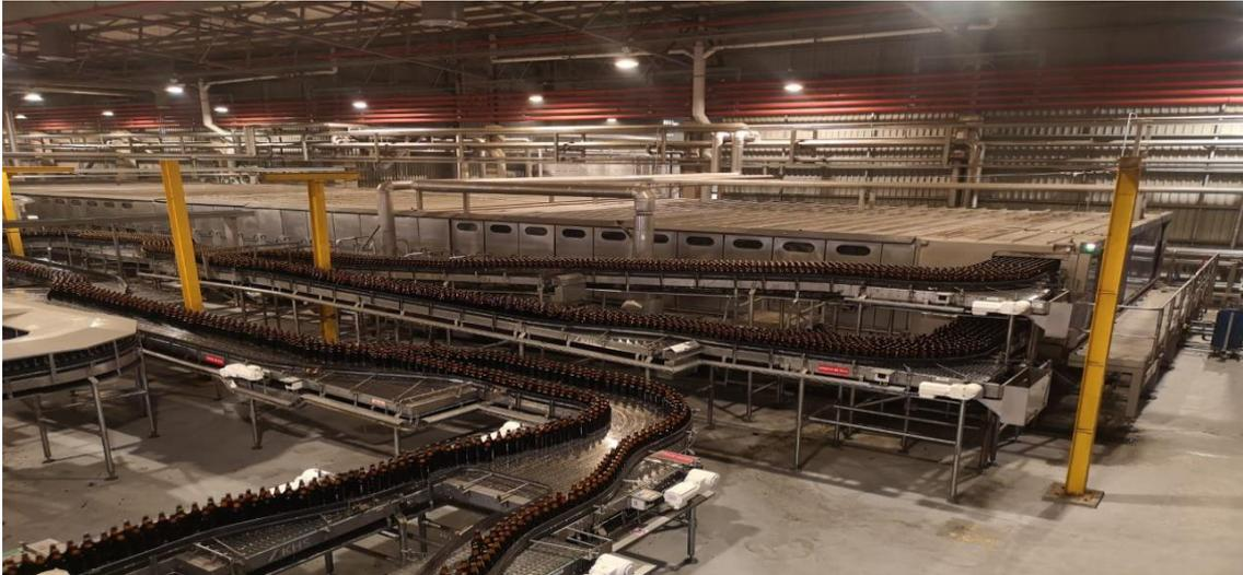
*Figura 13: Vista geral de uma Pasteurizadora de garrafas*
