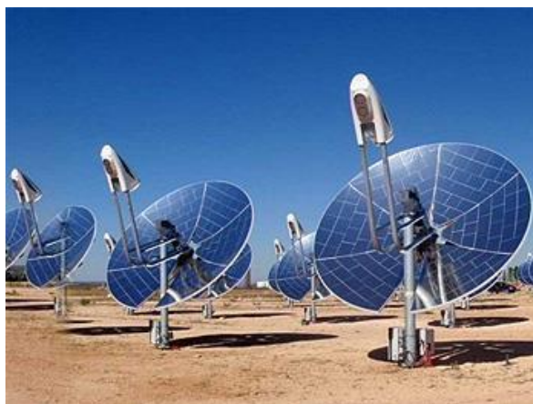
Figura 2.5— Colectores concentradores de discos parabólicos.
