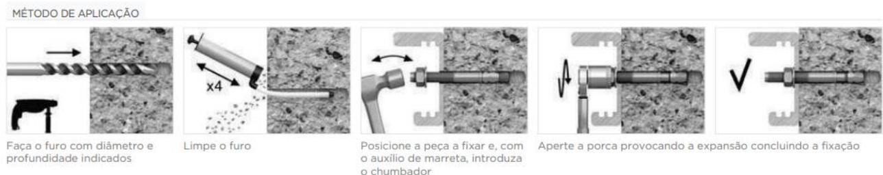
Figura 38. Método de aplicação dos chumbadores PBA
