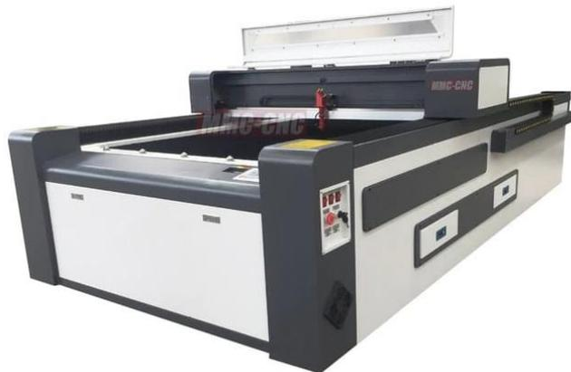
Figura 42. Máquina de corte a laser
