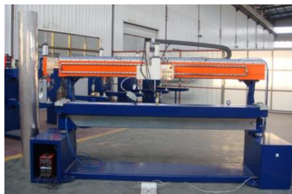
Fig. 12A Equipamento de Soldadura Longitudinal. Fonte: Fornecedor de equipamentos industriais
