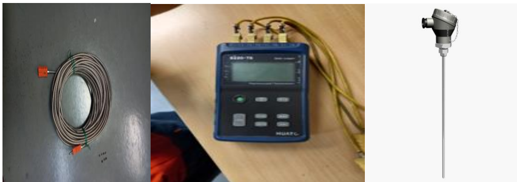
Figura 17 Cabo termopar tipo e um colector de dados.
