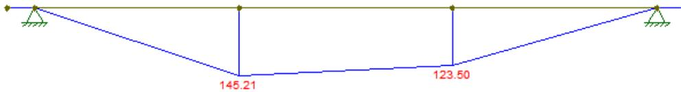
Fig. 3-13: Diagrama dos momentos flectores do veio intermédio do redutor.
