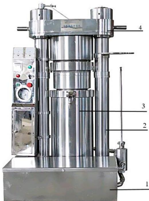
Fig.2-4: Exemplo de um modelo actual de prensa para extração de óleo (Adaptado).
