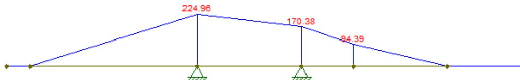
Fig. 3-10: Diagrama dos momentos fletores do veio de entrada do redutor.
