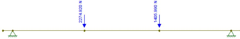
Fig. 3-11: Diagrama do corpo livre do veio intermédio do redutor.
