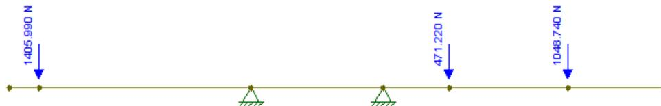
Fig. 3-8: Diagrama do corpo livre do veio de entrada do redutor.
