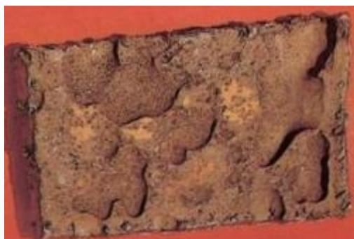
Figura 6: Corrosão por placas
