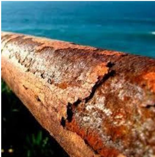
Figura 2: Corrosão electroquímica
