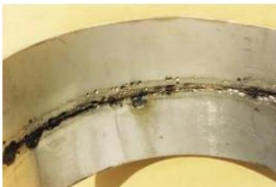
Figura 14: Corrosão em torno do cordão de solda
