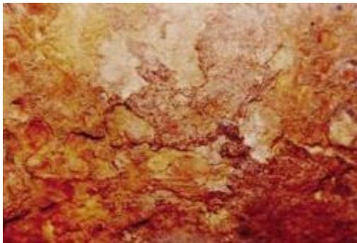
processar em toda a extensão da superfície do material (Figura 5). Esse tipo de corrosão ocasiona a perda uniforme da espessura da estrutura. Esta é a forma mais comum de corrosão, sendo facilmente visualizada a olho nu, permitindo a rápida recuperação ou substituição da secção atacada.
