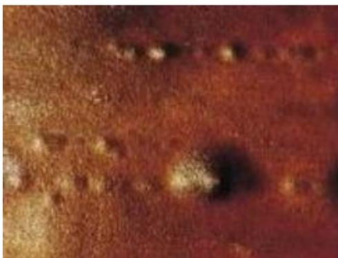
Figura 13: Corrosão por empolamento pelo hidrogênio
