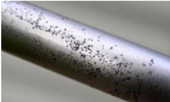
Figura 8: Corrosão por pite
