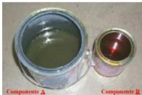
Figura 35: Componentes A (pigmento: pó de zinco e cargas especiais) e B (resina: epóxi - poliamida) do primer epóxi amida rico em zinco.
