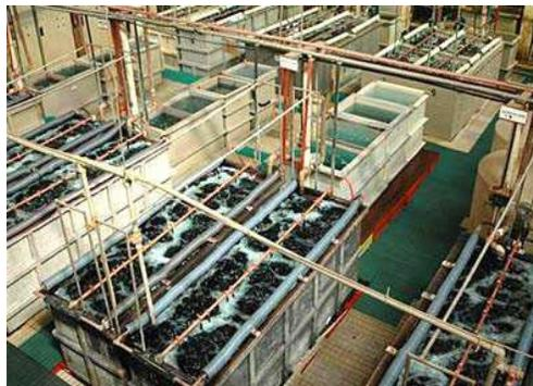
Figura 16: Processo de eletrodeposição.
