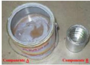
Figura 36: Componentes A (pigmento: tintoriais) e B (resina: poliéster – acrílico – isocianato alifático) do esmalte poliuretano alifático.
