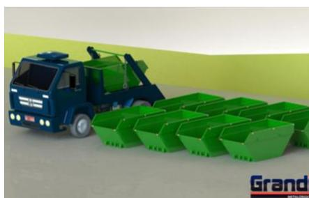
Figura 21: Caminhão equipado com equipamento poligüindaste simples e caçambas
