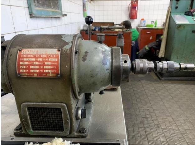
*Figura 10: Máquina rectificadora de agulhas e sedes dos bicos*
