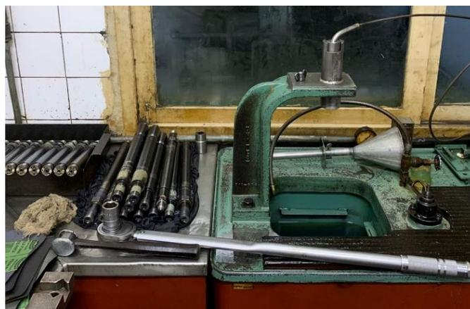
*Figura 12: Limpeza final dos bicos injectores*
