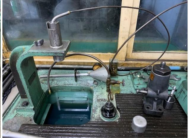
*Figura 11: Limpeza do bico injector*
