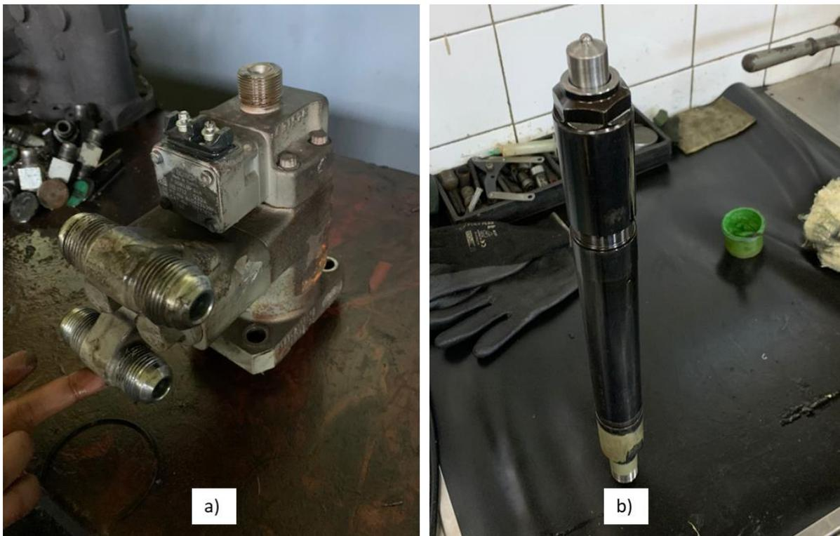
Figura 5: a) Bomba injectora com selenóide da locomotiva GE C30 ACI; b) Injector da locomotiva GE C30 ACI
