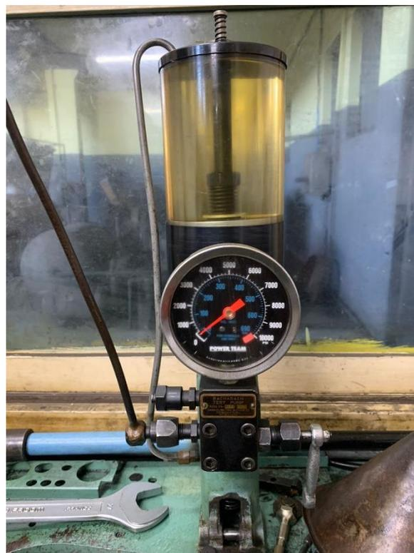
*Figura 13: Testagem dos injectores*
