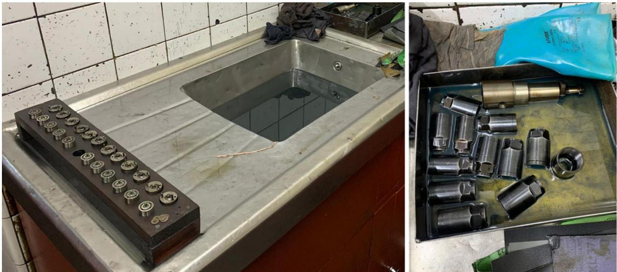
*Figura 9: Bancada de lavagem dos injectores.*
