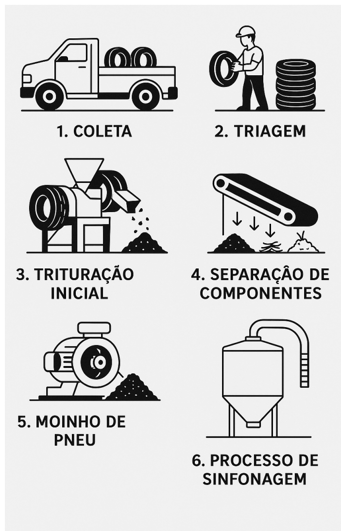
FIGURA 8: Esquema do processo de reaproveitamento do Pneu
