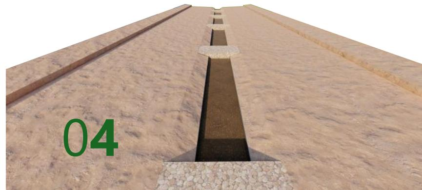
Sobre a brita, aplica-se uma camada de areia que serve como transição entre o material filtrante e a superfície superior da biovaleta. Esta camada contribui para estabilizar o solo e evitar a contaminação do sistema drenante.
