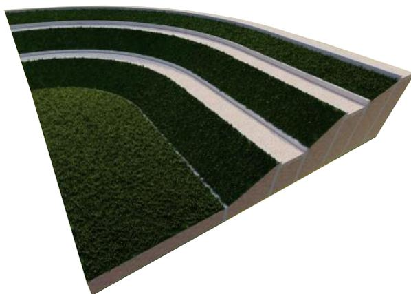
Com a estrutura principal da bacia completa, inicia-se o trabalho de revestimento da área filtrante e de recuo com terra vegetal, promovendo a infiltração da água no solo e permitindo a vegetação natural. Simultaneamente, as zonas pedonais que envolvem a bacia são preparadas com a aplicação de uma camada de brita ou solo compactado, que serve de base sólida para o pavimento.
