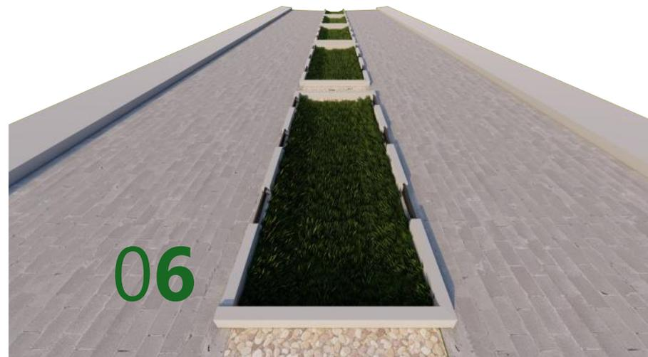
Instala-se um lancil de betão (150x250x600 mm) ao longo do bordo da biovaleta, acompanhado por uma grelha metálica que permite a entrada de águas pluviais e impede a entrada de resíduos sólidos.
