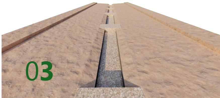
Inicia-se o enchimento do taboco com brita ou outro material granular drenante, formando a camada de enrocamento. Este material envolve os tubos perfurados e facilita a circulação da água ao seu redor.
