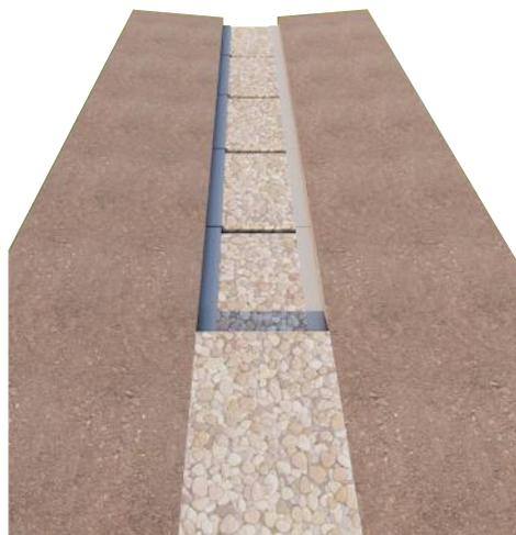
Após a instalação dos elementos pré-moldados, a vala é preenchida com brita ou material granular drenante à volta dos tubos e do sistema, para garantir a estabilidade e a eficiência do escoamento da água.
