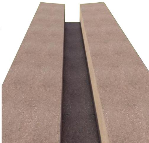
O processo começa com a limpeza da área de implantação da via, removendo-se a vegetação, detritos e solo superficial indesejado. De seguida, são abertas as valas (tabocos) onde serão inseridos os elementos pré-moldados de drenagem.
