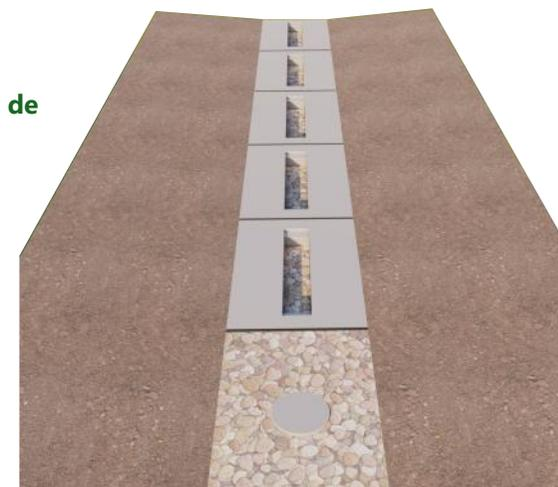
É colocada uma tampa de betão sobre os canais pré-moldados, que permite o acesso ao sistema para inspeção e manutenção sempre que necessário.
