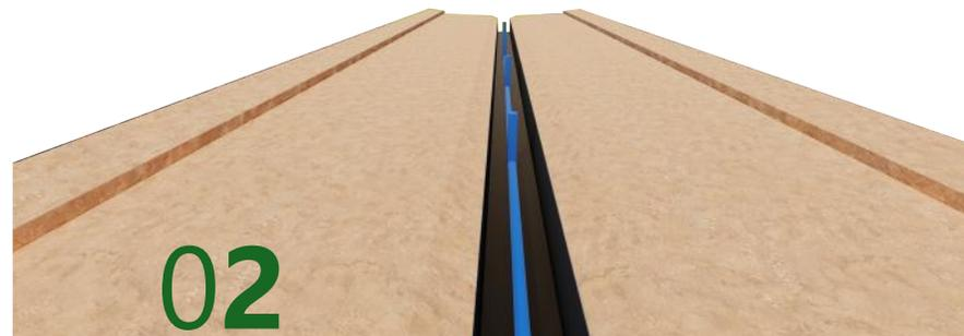
Com os tabocos abertos, reveste-se o interior com manta geotêxtil, que evita o entupimento do sistema filtrante por partículas finas. Após este passo, são inseridos os tubos perfurados, que recolhem a água infiltrada no solo e a conduzem ao destino previsto.
