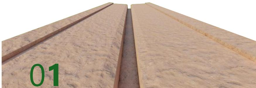
O processo inicia-se com a limpeza da área onde será implantada a via e as biovaletas. Remove-se a vegetação, detritos e solo superficial indesejado. De seguida, procede-se à abertura dos tabocos (valas lineares), que correspondem à base onde funcionará a drenagem da biovaleta.
