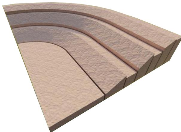
Após a escavação geral, são preparados os espaços laterais onde serão construídos os taludes. Esta preparação é essencial para receber a estrutura em betão, garantindo que a fundação dos taludes fique bem integrada no corpo da bacia.
