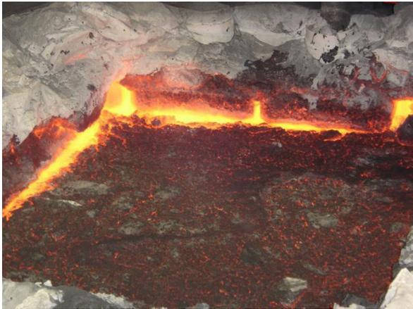
Figura A1: Ilustração de pó de monóxido de carbono na superfície do banho electrolítico
