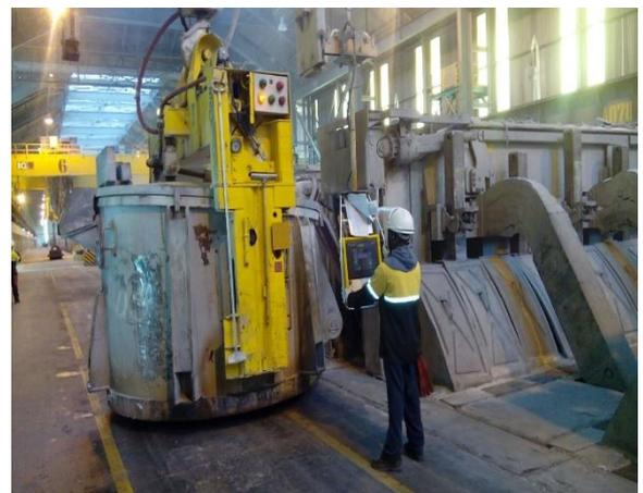
Figura A6: Ilustração do processo de sucção de metal no pote
