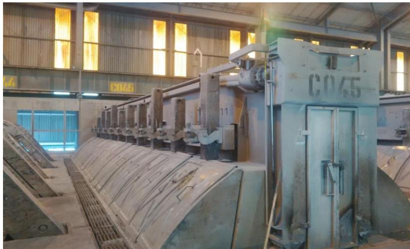
Figura 3.6: Célula electrolítica do modelo APXLE da Mozal (Fonte: Mozal)
