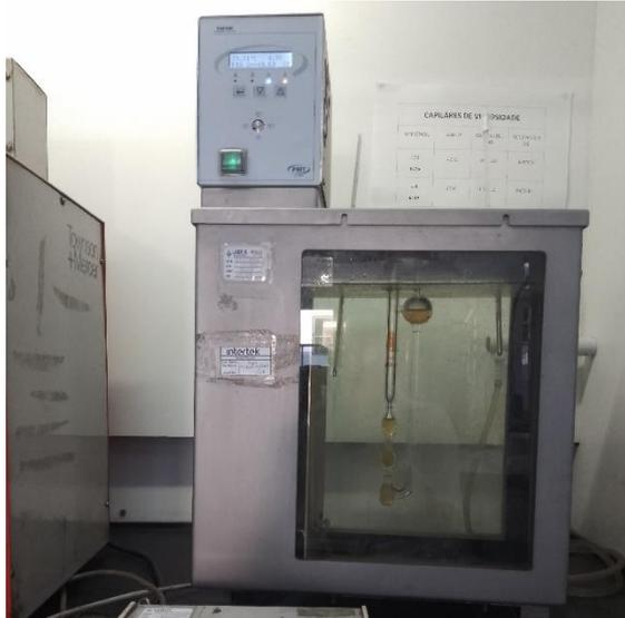
Figura 7: Viscosímetro de 40 °C
