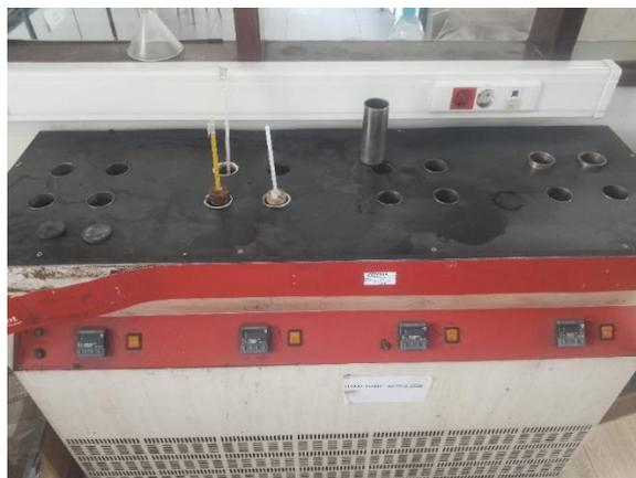
Figura 11: Determinação do ponto de fluidez de algumas amostras
