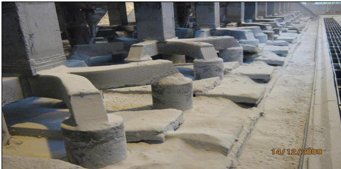
**Figura 6.** Preenchimento de  $\text{Na}_2\text{CO}_3$  e criolita para a cobertura sobre os ânodos.
