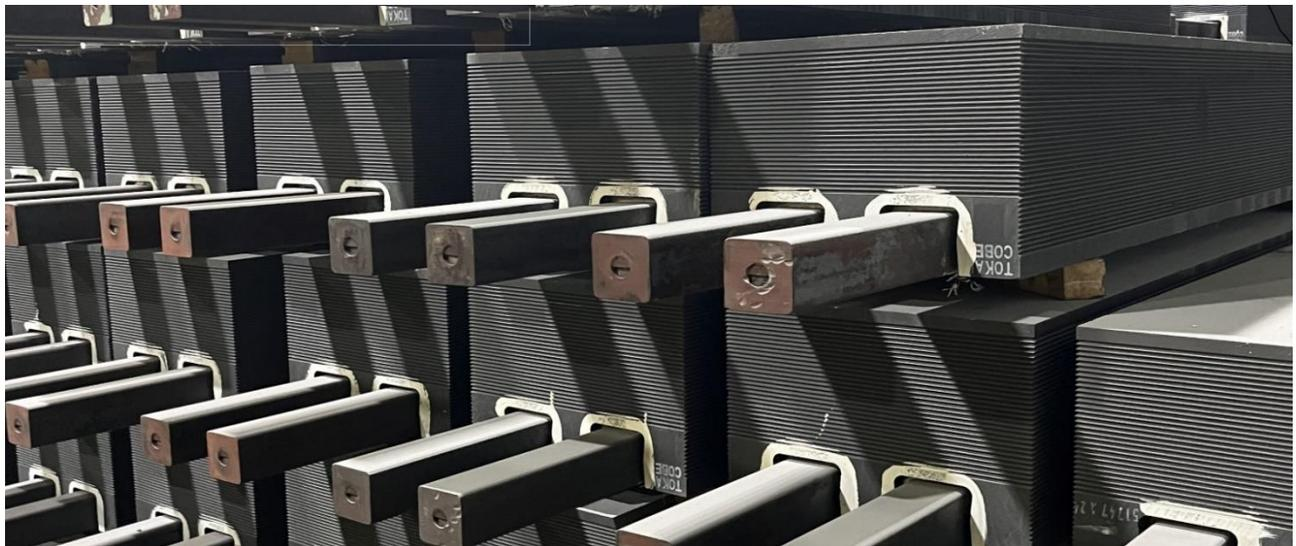
**Figura 13.** Blocos catódicos e suas respectivas barras colectoras, comunitamente utilizados na indústria de produção de alumínio.
