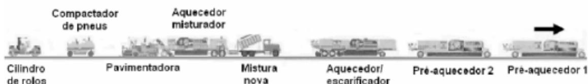
*Figura 18: Esquema do "comboio" de intervenção no processo de reciclagem "in situ" a quente com betume/rejuvenescedor (Martinho, 2005).*
