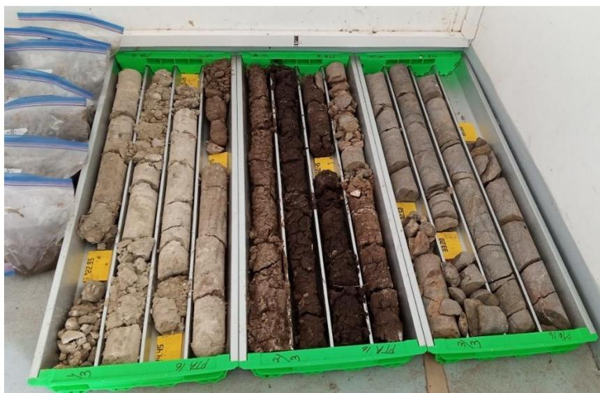
Figura 3.3 - Amostras extraídas durante a instalação dos piezômetros.
