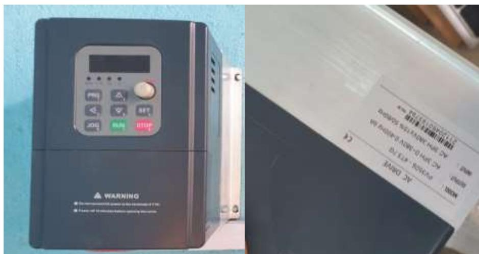
*Figure 15 Inversor de frequência da bomba escolhida.*
