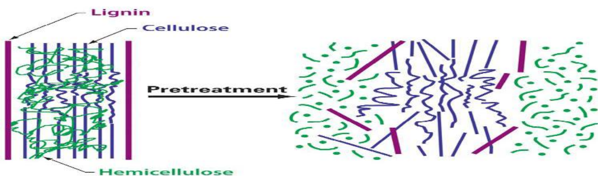
Figura 7: Representação da deslignificação (Dias, 2011)
