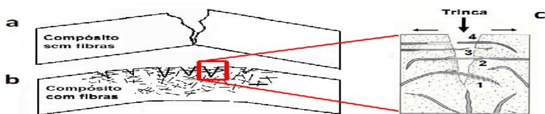
Figura 8: Representação esquemática do comportamento sob flexão de um compósito: a) sem fibras, e b) reforçado com fibras, c) detalhe do caminhamento da trinca através do compósito reforçado com fibras: (Pontos 1 e 2) descolamento da fibra, 3) arrancamento (pull-out) da fibra, (ponto 4) rompimento da fibra Coutts (1988) citado por (Tonoli, 2009).
