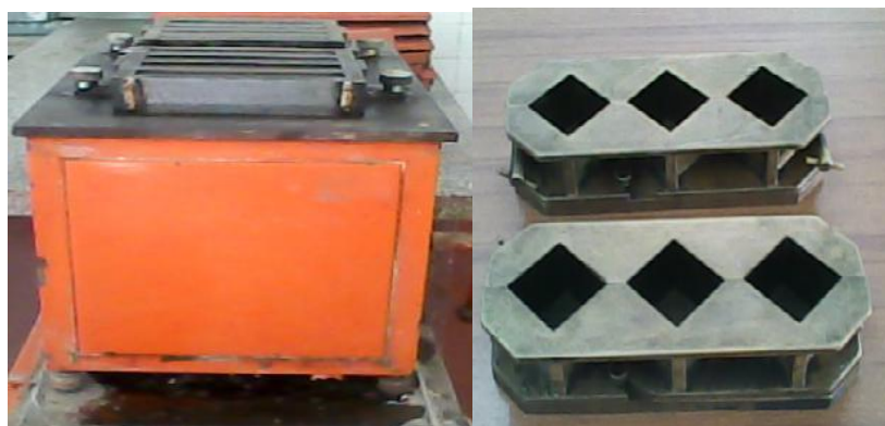
Figura 15: Prensas de moldagem de corpos de prova prismáticos (à esquerda) e cúbicos (à direita)
