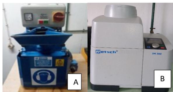
Figura 6: A-Moinho de facas e B-Moinho ultracentrifugo
