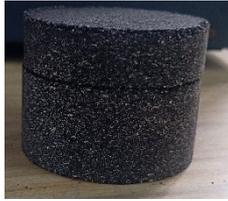
Figura 23: Briquete quebrado e esfarelado produzido a partir de SMC-25%-75%
