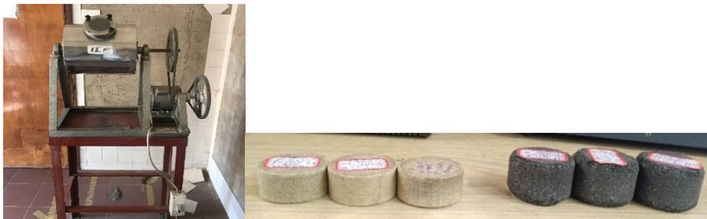
Figura 14: Tambor rotativo utilizado para a friabilidade e Briquetes depois do teste de friabilidade
