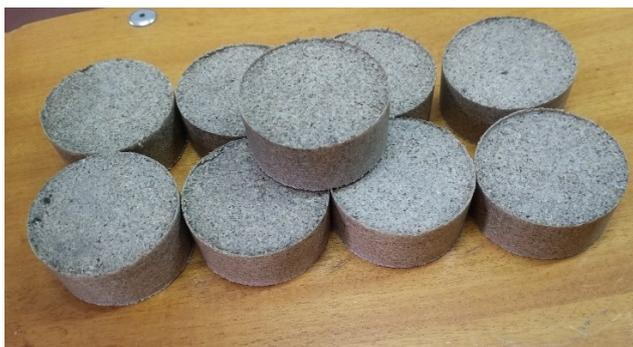
Figura 4: Briquetes feitos por material agrícola
