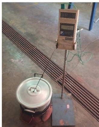
Figura 16: Equipamento usado para o teste de fervura da água
