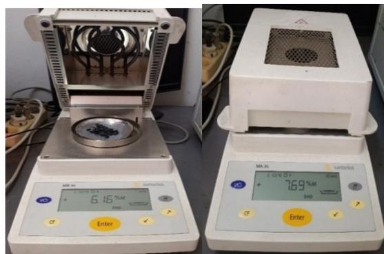
Figura 9: Medidor de humidade
