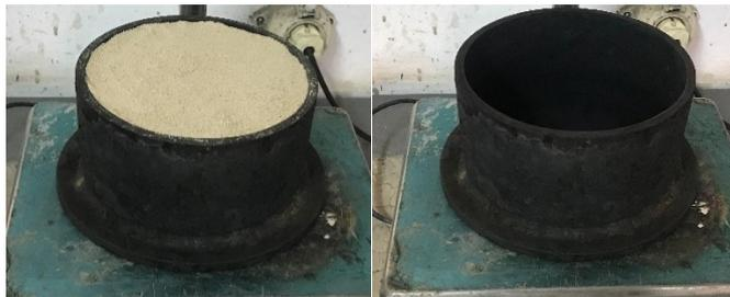
Figura 7: Reactor com as amostras antes e depois da carbonização
