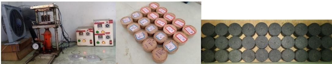
Figura 12: Equipamento utilizado para a produção de briquetes; Briquetes de sabugo de milho (SM); Briquetes da mistura de sabugo de milho e sabugo de milho carbonizado em 50:50 (SMC-50%-50%)
