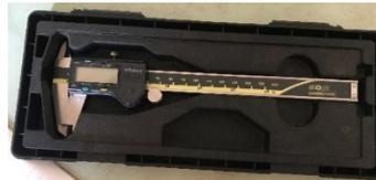
Figura 13: Paquímetro digital utilizado para a medição da expansão dos briquetes
