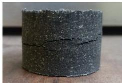
Figura 19: Briquete quebrado pela influência de humidade alta, acima de 12%
