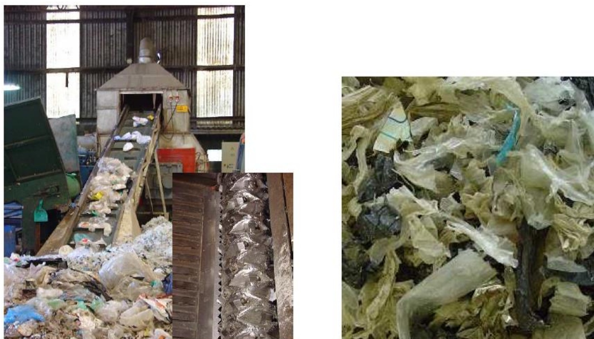
Figura 2: Triturador de corte: aspecto exterior e eixo de corte (à esquerda) Polietileno de alta e baixa densidade triturados (à direita)
