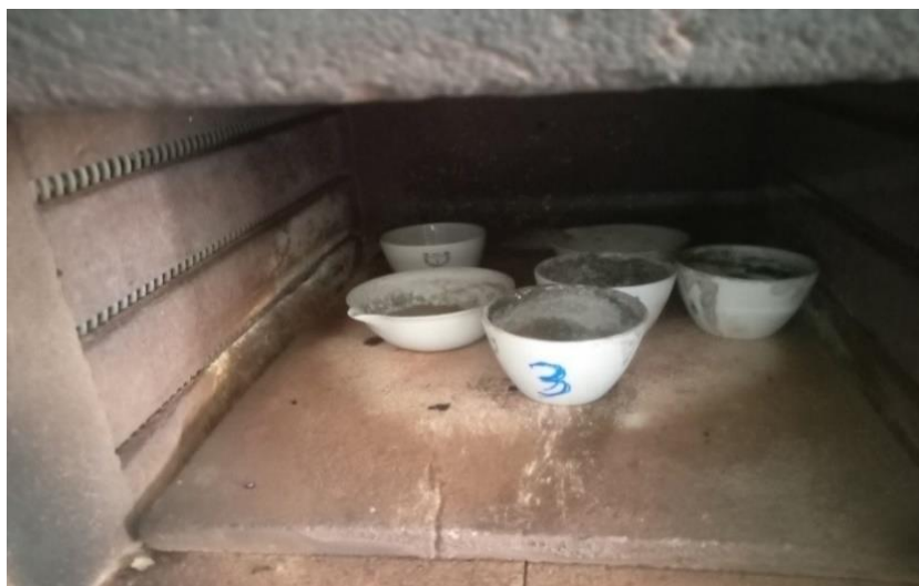
Figura 11: Amostras de lama na mufla para determinação da matéria orgânica
