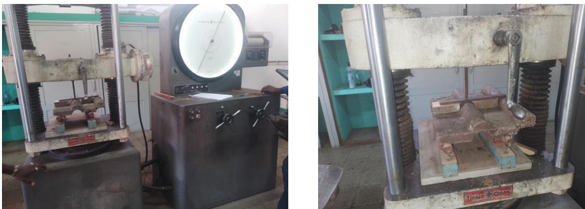
Figura 21: Momento do ensaio de flexão e prensa utilizada. Fonte: autor
