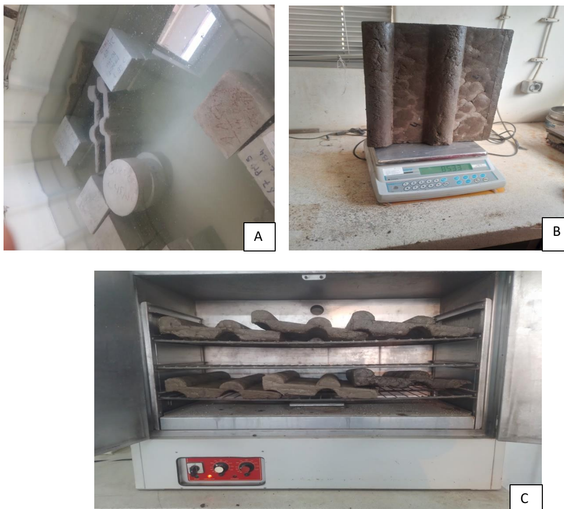
Figura 20: A — Amostras submersas na água, B — Pesagem da amostra, C — Amostras na estufa Fonte: Autor
