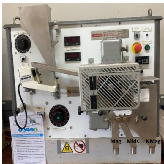
Figura 14: Separador de rolo induzido na escala laboratorial
