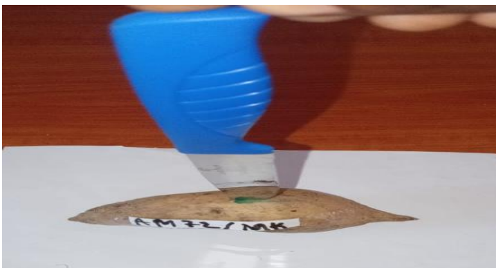
APÊNDICE 3: Mensuração da textura com auxílio de uma faca submetida a pressão
