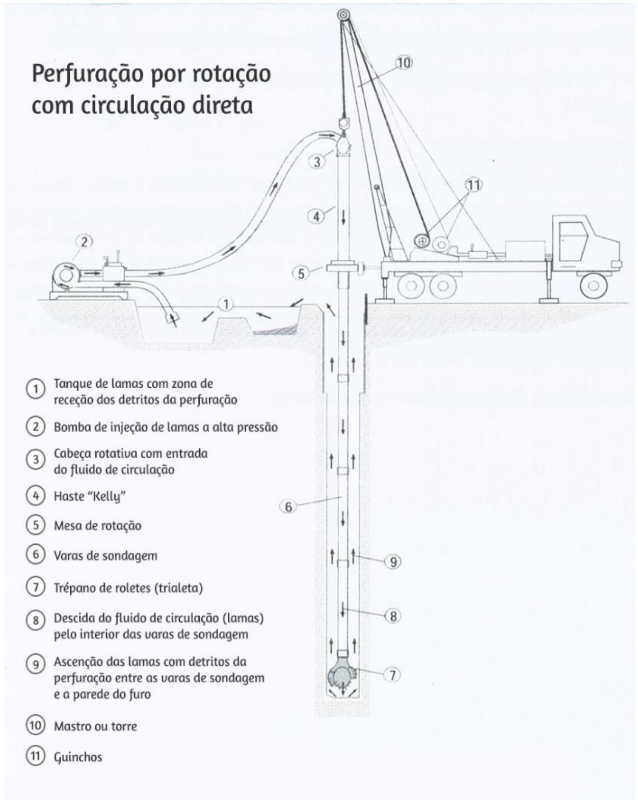
Figura 49: Perfuração por Rotação com Circulação Directa (Baptista, 2016).
