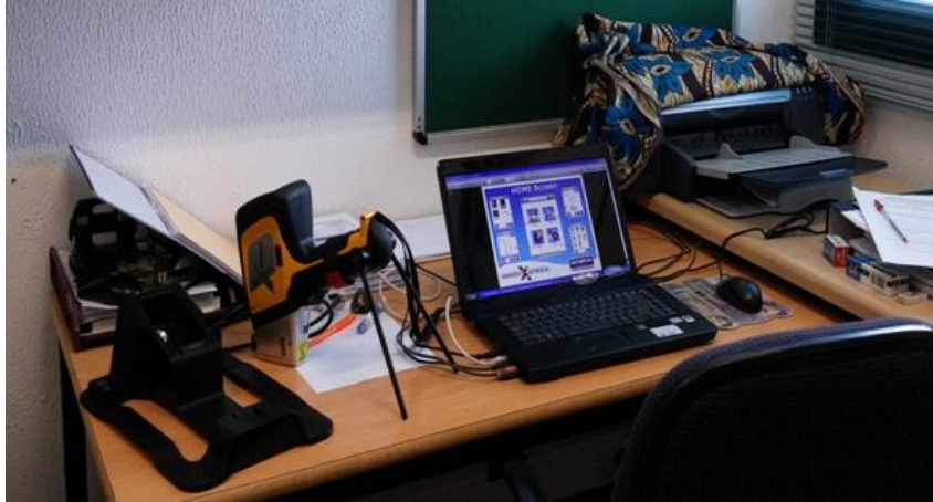
Figura 10: Espectrômetro de Raios X, de marca OLYMPUS DELTS XRF Professional Analyzer-Rh TUBE, equipado com tubo de Ródio (Rh), detector derivado de Silício (SSD) e um analisador multicanal de amplitude (MCA), conectado a um computador portátil.
