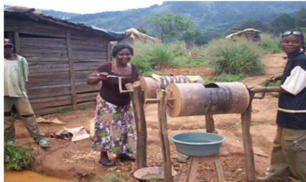
Foto 3: Ilustração de um moinho ( ballmill ) em Mimosa onde uma inquiridora testa o processo do funcionamento do moinho.
