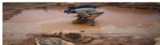
Foto 4: Ilustração do mecanismo de bateia pelo uso de bacias (Munhena)
