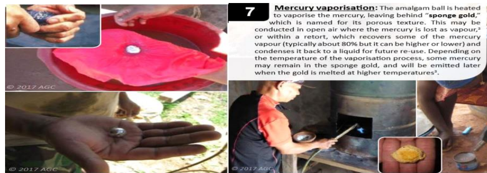
Figura 3: a) Amálgama; b) Processo de vaporização e ouro esponjoso;
