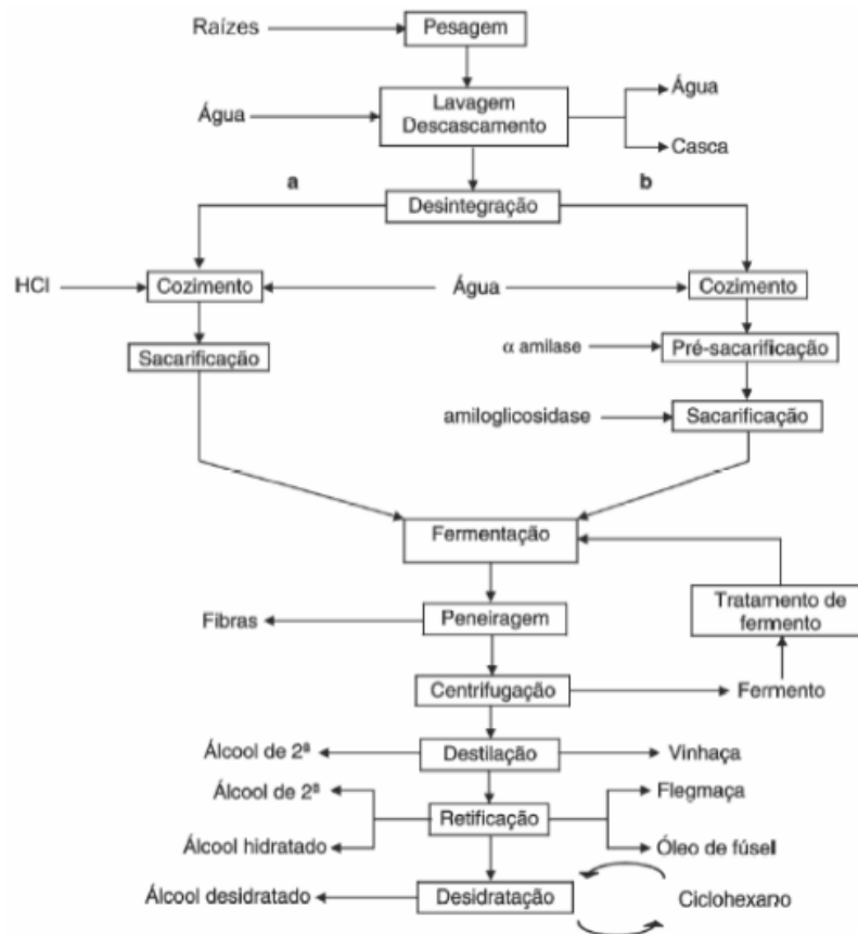
Figura 8. Etapas de produção de etanol a partir da mandioca
