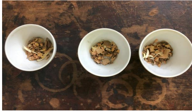
Figura 12. Preparação da amostra para determinação de humidade, sólidos totais, voláteis e fixos
