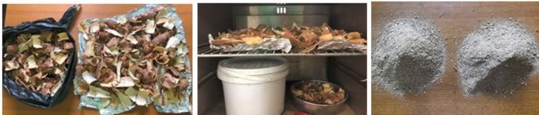
Figura 13. Pré-tratamento da amostra (secagem na estufa e trituração)
