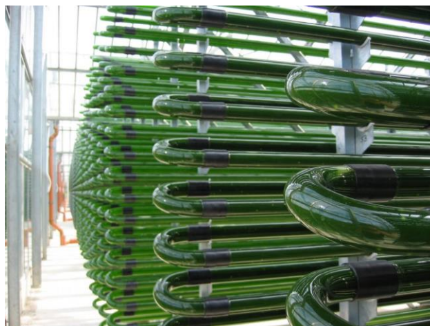
Figura 5. Cultivo de microalgas em reactores tubulares para produção de biocombustíveis de terceira geração
