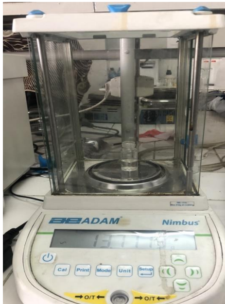
Figura 18. Determinação da densidade através da picnometria
