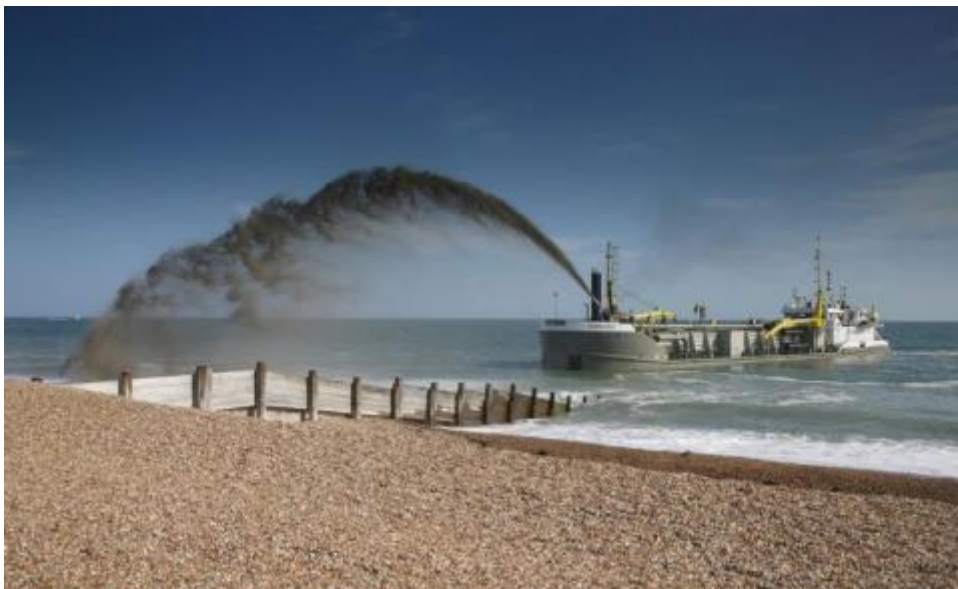
Figura 2: Ilustração da draga autotransportadora de arrasto Sospan Dau, realizando o engordamento da Ilha Hayling no Reino Unido. (Oliveira, 2010).
