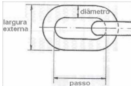
Figura 3: Principais dimensões do elo
