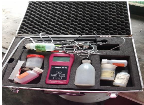
Figura 5: COMBI 5000 usado para medir os parâmetros CE e pH.
