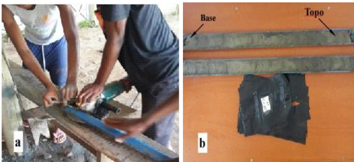
Figura 6: a) Corte dos tubos de PVC; b) Amostras de sedimentos prontas para o confeccionamento em sacos plásticos
