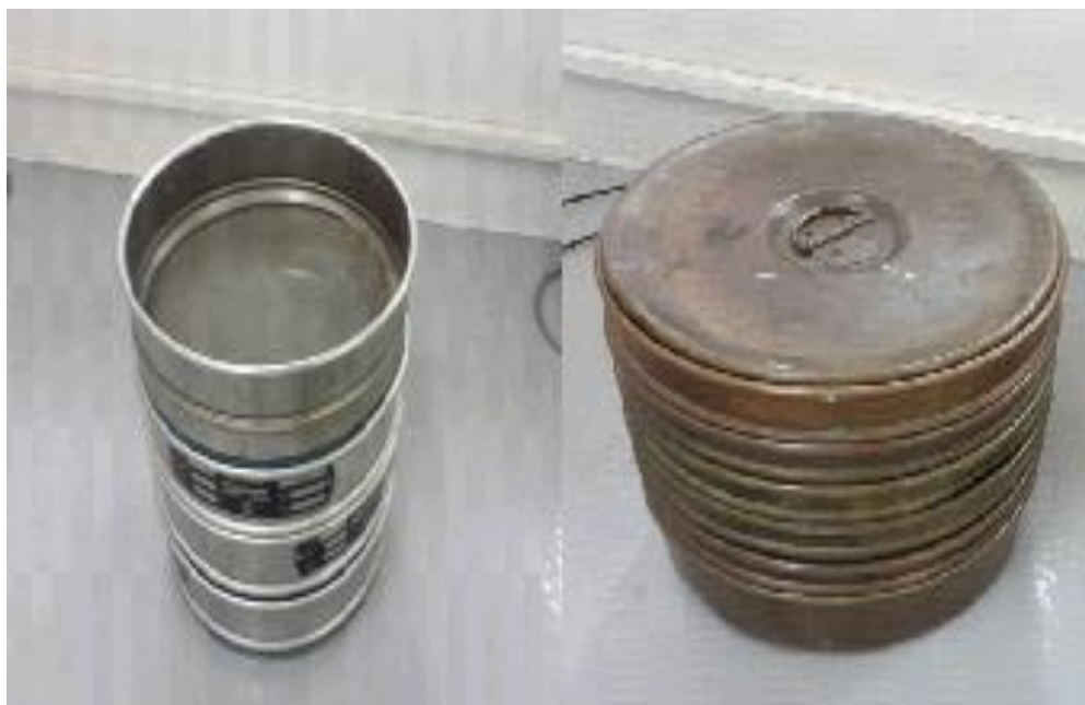
Figura 8: Peneiras granulométricas, usadas para a crivagem das amostras
