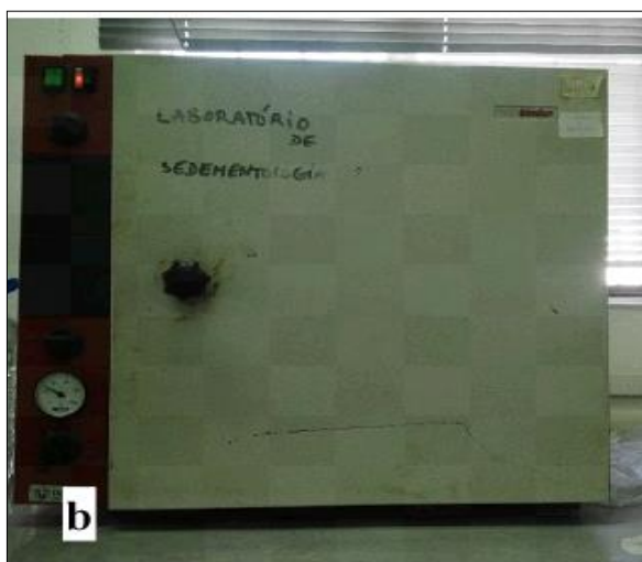
Figura 7: a) Balança XS-210 com precisão de 0,001 g, usada para pesar as amostras; b) Estufa WT Binder, usada para secar amostras; c) Oxidação da matéria orgânica.
