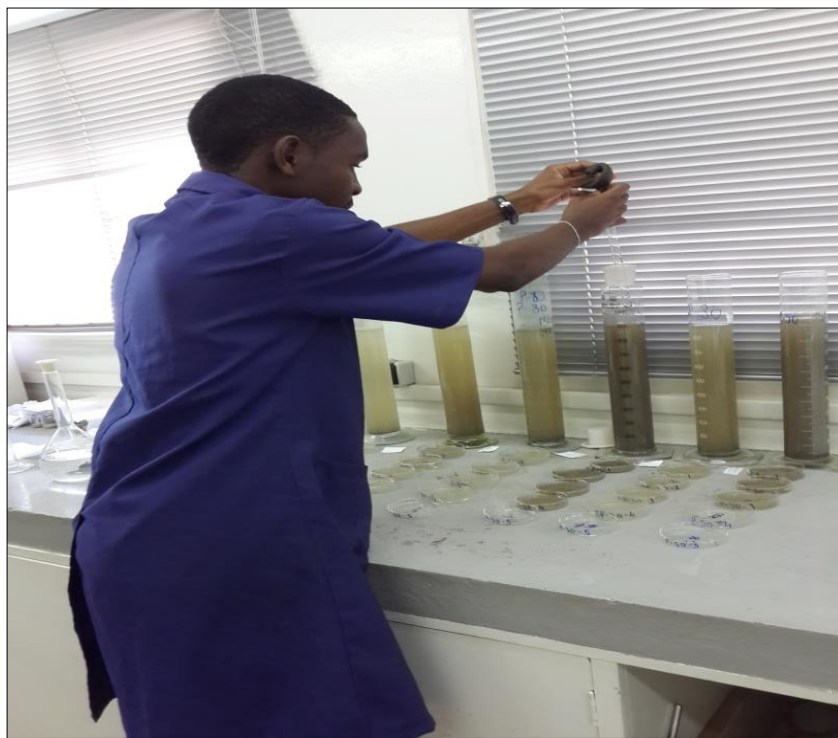
Figura 9: Colecta das fracções granulométricas dos sedimentos pelíticos (silte e argila)
