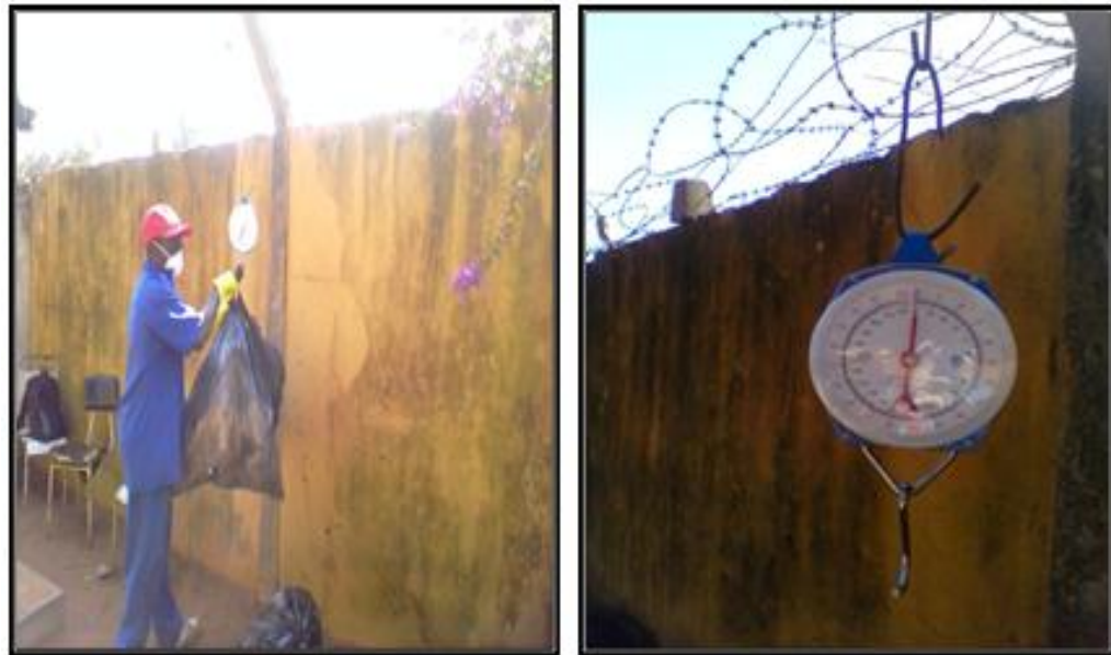
Figura nº 9: Pesagem e a Balança Utilizada para Determinação das Quantidades dos Resíduos Gerados Fonte: Autor, 2015
