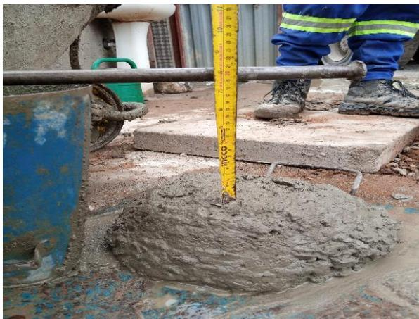
Figura 55: Teste de abaixamento (Fonte-autor)
