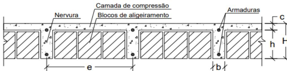
Figura 5: Secção transversal da zona aligeirada de uma laje fungiforme aligeirada(Tesouro, 1991).
