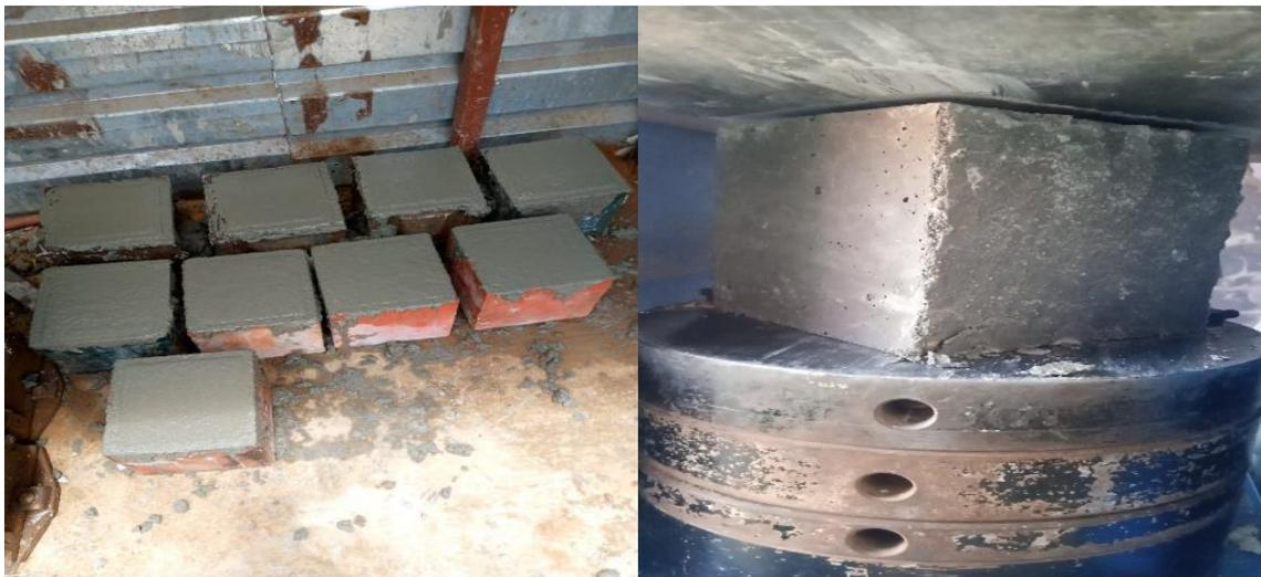
Figura 56: Extração de amostras para ensaio de compressão (Fonte-autor)
