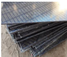
Figura 26 - Placas de madeira para cofragens
