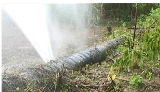
*Figura 15: Rotura de tubagem por impacto. Fonte: Disponível em: <<https://eluniverso.com/noticias/2019/10/26/nota/7576559/esmeraldas-esta-agua-nueva-rotura-tuberia/%3foutputType=amp>> Acesso em Março de 2022.*
