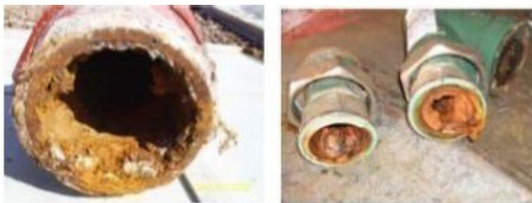
*Figura 13: Formação de incrustações nas tubulações. Fonte: MACEDO (2015).*
