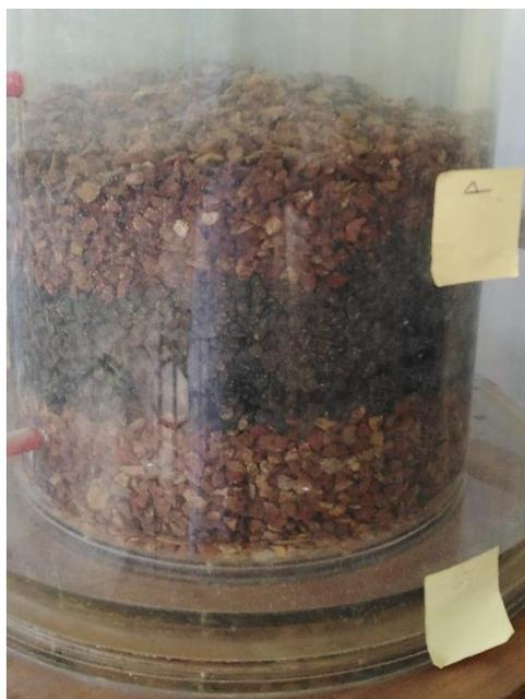
**Figura 3.5** Colocação da brita na coluna.
