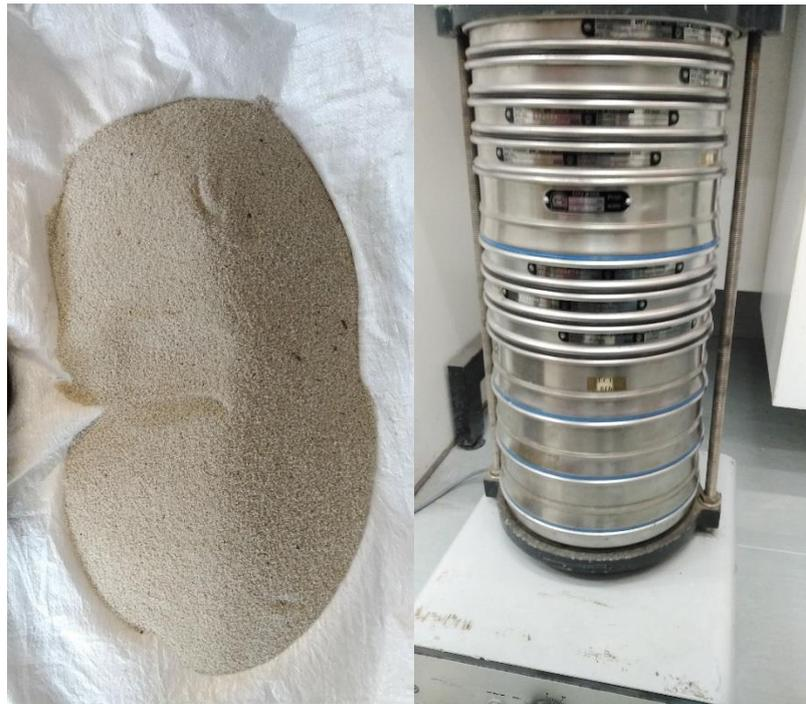
**Figura 3.6** Preparação da areia para o filtro rápido. Areia antes do ensaio (lado esquerdo); Agitador electromagnético com peneiros para ensaio de areias (lado direito).
