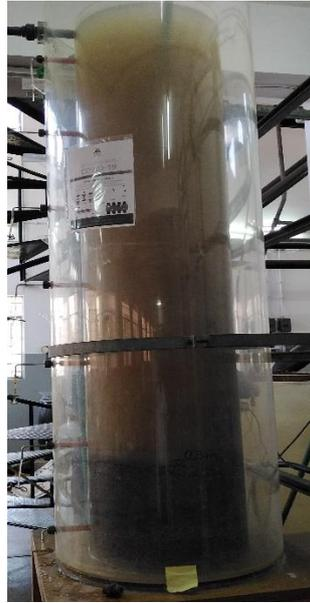
**Figura 4.8** Flocos em suspensão após o accionamento da bomba.
