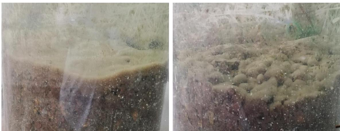
**Figura 5.1** Manta de flocos no topo do leito granular nas diferentes séries de ensaio.  $T_f = 1,0$  m/h (esquerda: dose óptima; direita: metade da dose óptima)
