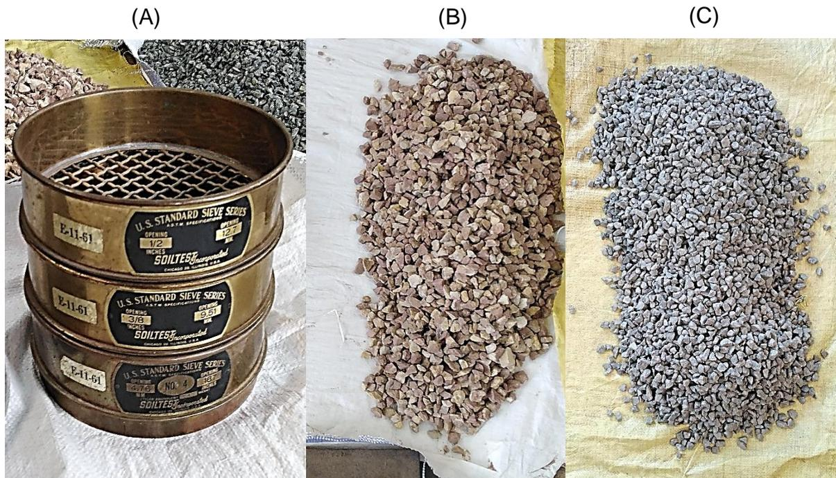
**Figura 3.4** Preparação do material para o leito do Pré-filtro. (A): Peneiros para crivagem da brita; (B): Riolito com 1/2"; (C): Basalto com 1/2".
