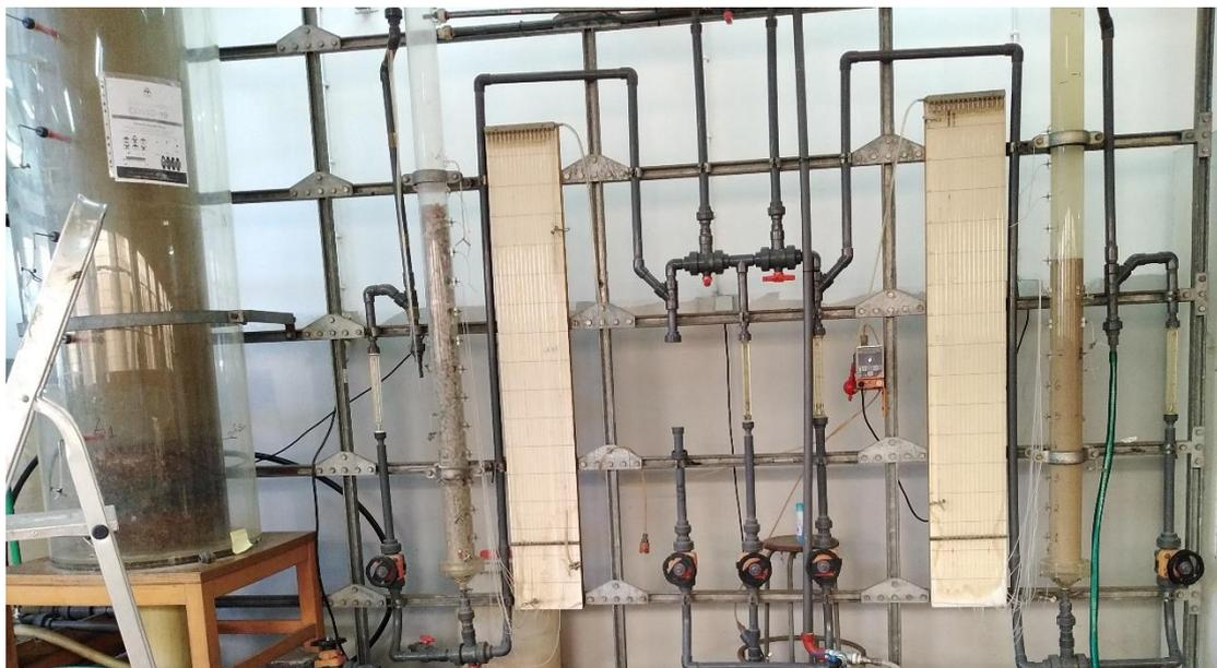
**Figura 1.1** Instalação piloto em funcionamento. Esquerda: floculador hidráulico; direita: filtro de areia.
