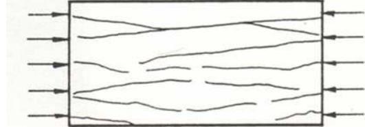
Figura 5: Fissura gerada por um esforço de compressão (Branco, 2005).
