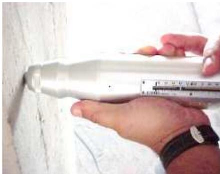
Figura13:Esclerómetro. (Ferreira, 2010)
