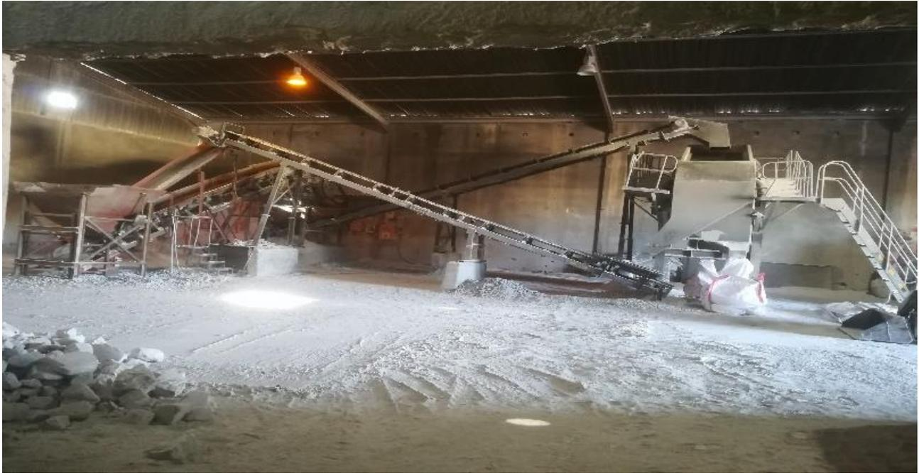
Figura 3. Esteira transportadora de três linhas
