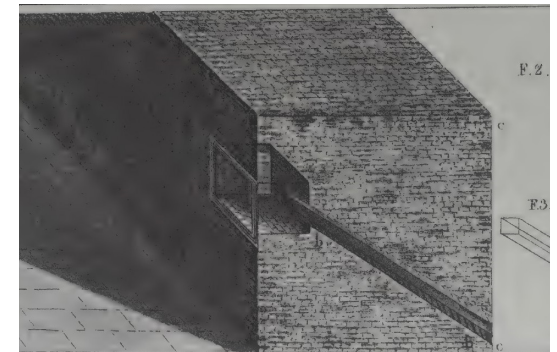
Figura 13. Prisão de Monges, Catedral de Worcester, Corte da parede no compartimento principal que tem um poço que permite aos prisioneiros ver o altar. Fonte: Johnston, 2000
