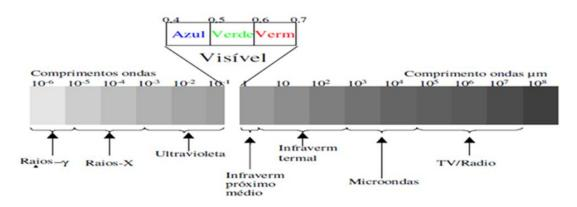
Figura 3 - Espetro eletromagnético
