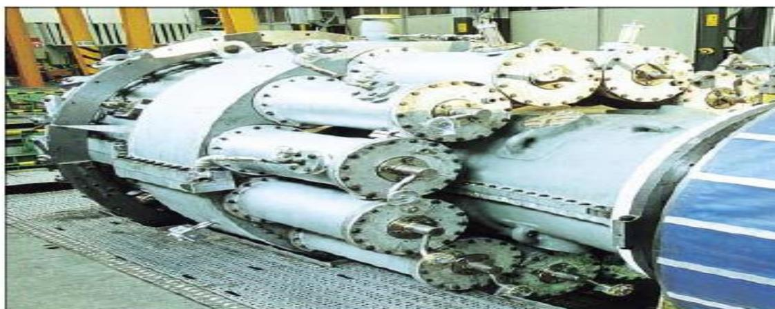
**Figura 2.3 – Câmara de combustão tubular.**
