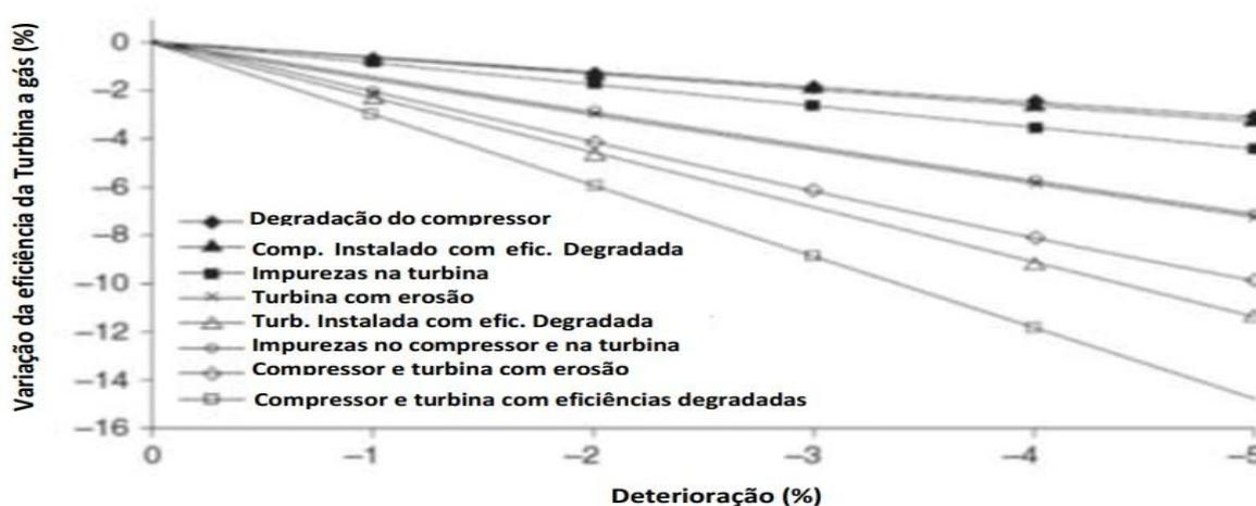
Gráfico 3.2 - Eficiência da turbina a gás em relação aos tipos de degradação.
