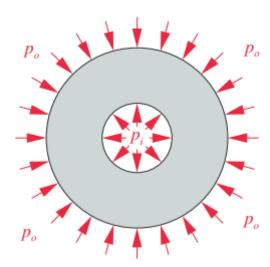
Figura 4.11: Cilindro submetido a pressão interna e externa. Fonte:[32]
