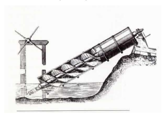
Figura 2.10:Bomba de Arquimedes. fonte[27]
