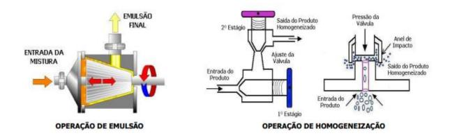
Figura 2.2.: Operação de redução de tamanho para alimentos liquido[30].
