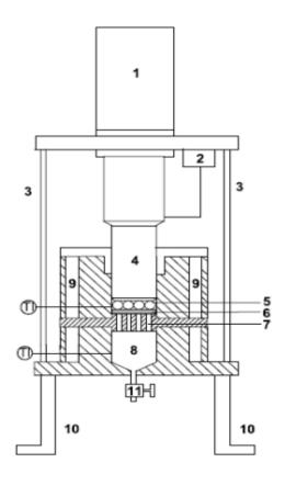
Figura 2.9:Representação esquemática de uma prensa hidráulica. fonte [25]
