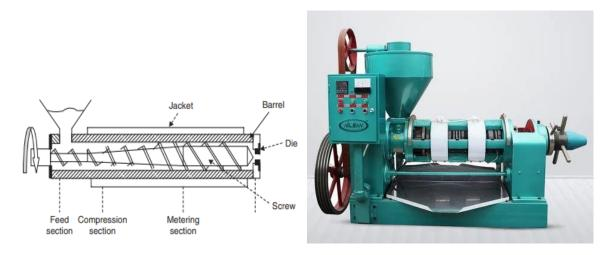
Figura 2.11: Desenho esquemático de prensa de parafuso fonte:[30]
