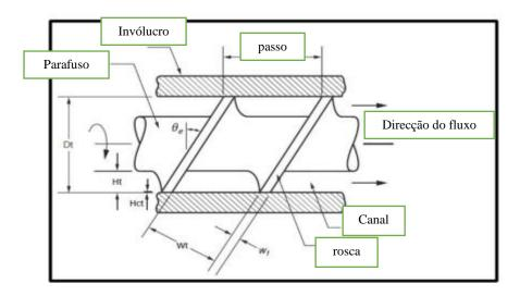
Figura 4.7: Detalhes do parafuso sem-fim. Fonte adaptado[7]
