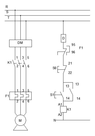
Figura 4.15: Circuito de accionamento do motor
