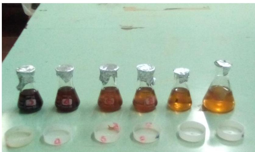
**Figura 3.6:** Soluções aquosa da *euclea natalensis* após o processo de Adsorção com bentonite a 2, 4, 6, 8, 10 e 12 gramas respectivamente
