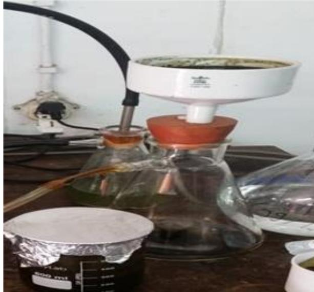
**Figura A2.7:** Operação de filtração da mistura da *euclea natalensis* e adsorvente (bentonite)
