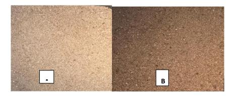
Figura 4. Serradura de Julbernardia globiflora; A- Serradura do borne e B- Serradura do cerne
