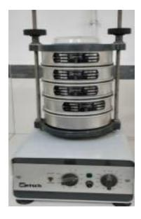
Figura 5. Peneiradora vibratória.
