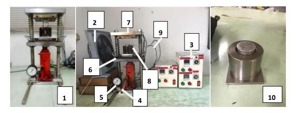
Figura 7. Prensa usada na briquetagem.
