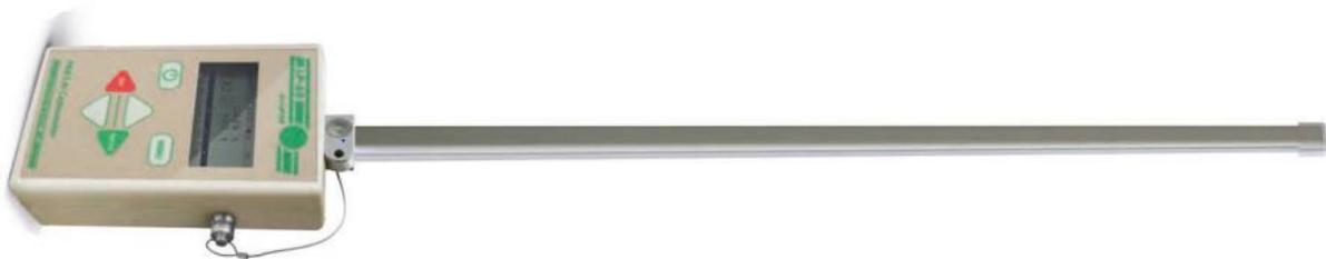
Figura 7: Vista espacial do AccuPAR LP-80/LAI Ceptômetro
