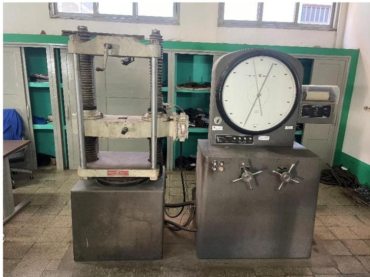
**Figura 3.3:** Prensa hidráulica usada para determinação da resistência ao esmagamento do agregado.
