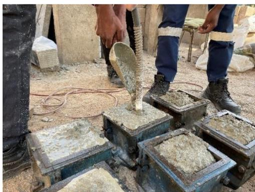
**Figura 3.11:** Processo enchimento e vibração dos moldes
