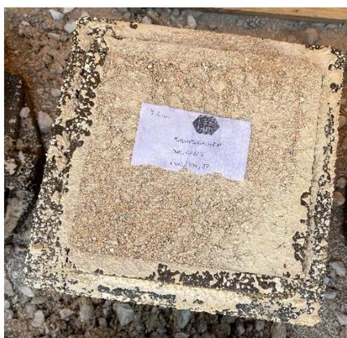
**Figura 4.2:** Provete de betão branco com superfície áspera
