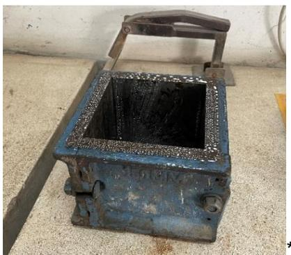
**Figura 3.10:** Molde preparado com aplicação de óleo descofrante
