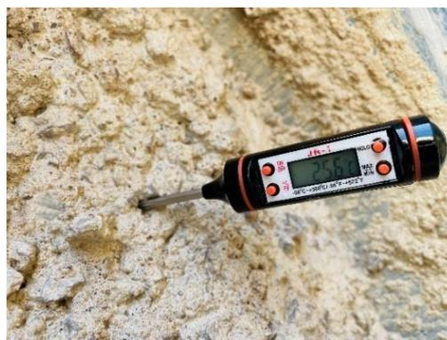
**Figura 3.12:** Medição da temperatura do betão fresco
