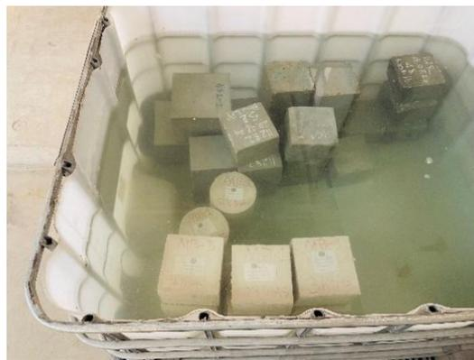
**Figura 3.14:** Processo de cura dos provetes de betão no tanque de cura
