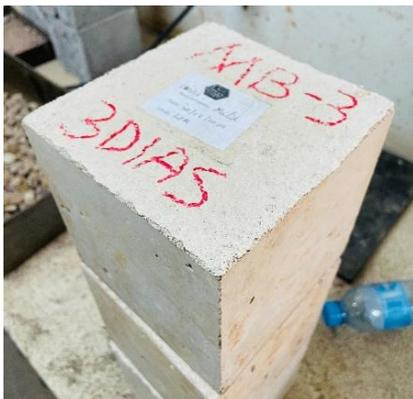
**Figura 3.13:** Identificação dos provetes de betão
