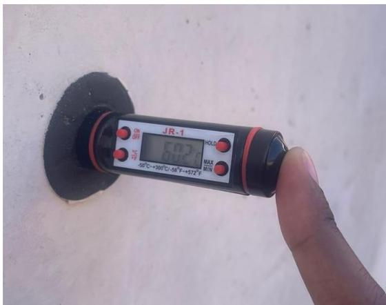
**Figura 4.7:** Registo de temperatura do betão branco aplicado na parede após descofragem
