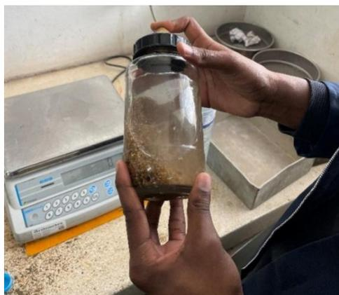
**Figura 3.7:** Picnómetro contendo areia e água
