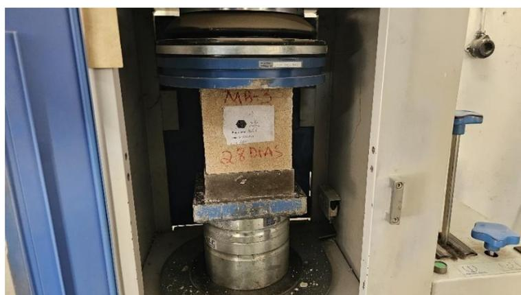
**Figura 3.16:** Ensaio de compressão axial do provete de betão
