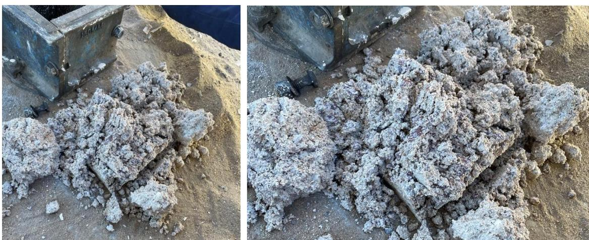
**Figura 4.4:** Betão branco não endurecido após 24 horas de cura devido a sobredosagem de adjuvante
