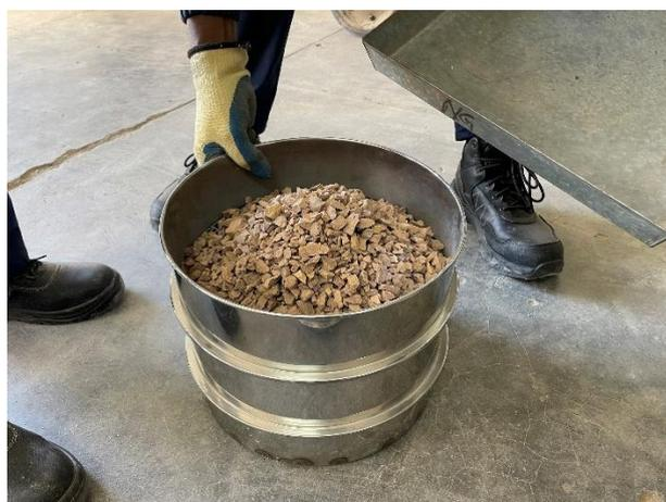
**Figura 3.1:** Agregado retido no peneiro
