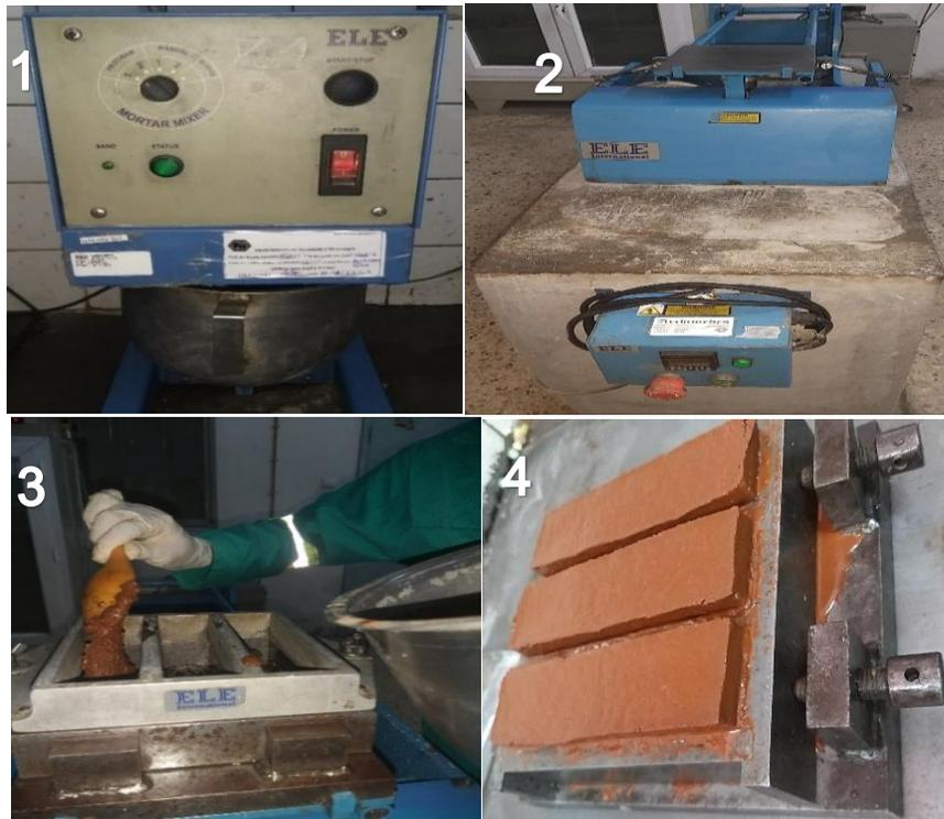
Figura 15: Equipamentos e algumas etapas de preparação de provetes:(1) Misturadora , (2) Compactador, (3) preenchimento do molde com argamassa e (4) molde com argamassa.
