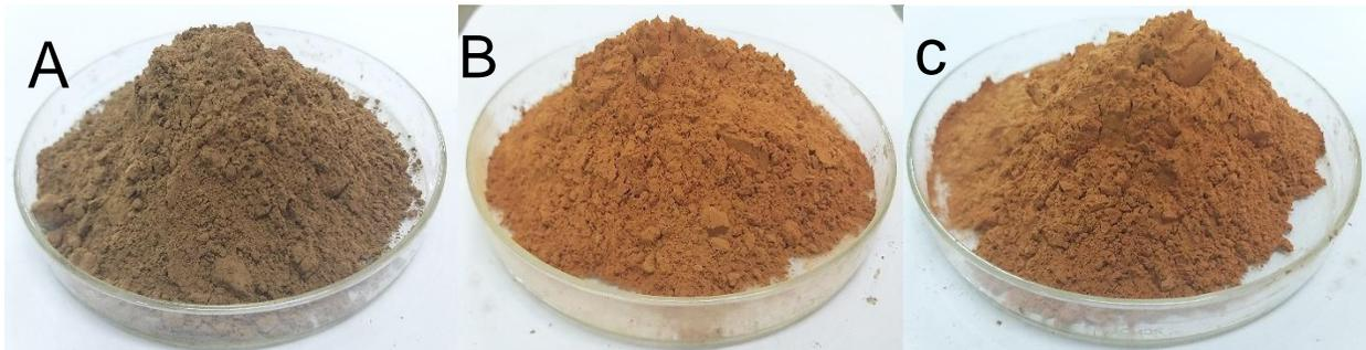
Figura 10: Lama não calcinada (A), lama calcinada a 700°C (B) e lama calcinada e 800°C.
