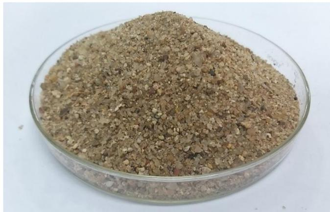
Figura 13: Areia usada na preparação de corpos de prova.
