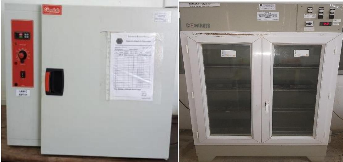
Figura 16: Equipamentos usados para cura dos provetes: Estufa; Câmara de estufa.
