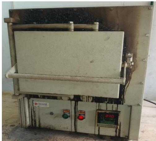
Figura 9: Mufla usada na calcinação
