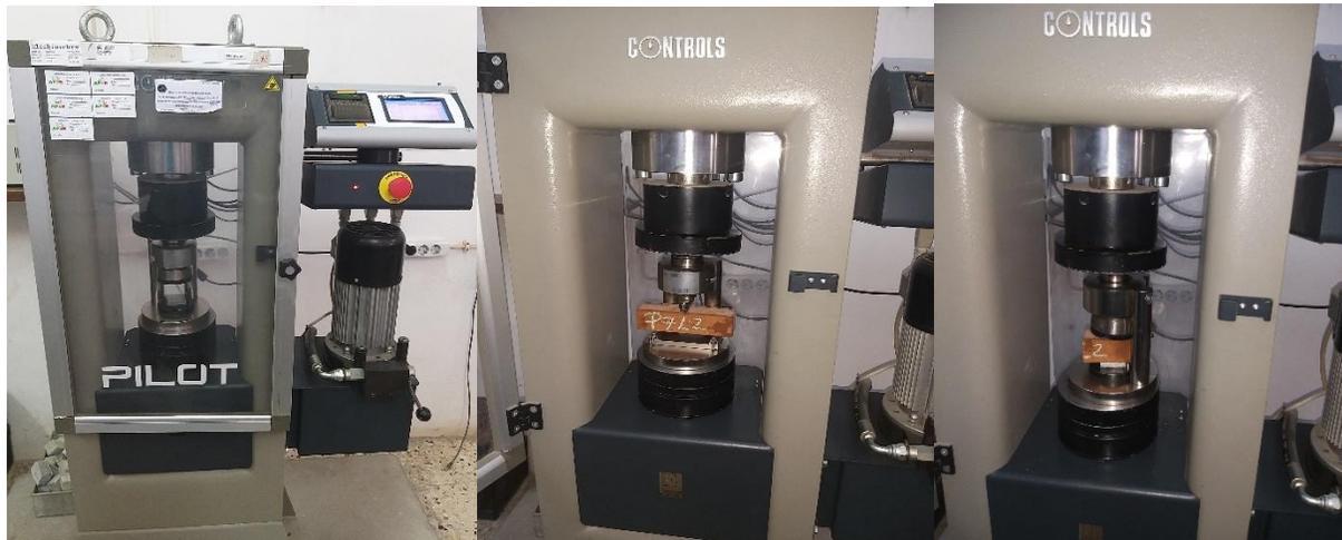
Figura 18: Prensa hidráulica usada nos ensaios de resistência a flexão e compressão, com os provetes para os ensaios.
