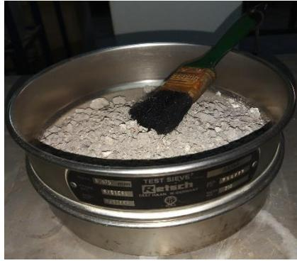
Figura 12: Peneiro com amostra de cinza.
