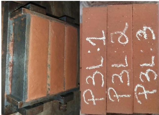
Figura 17: Provetes antes de desmoldar e devidamente identificados depois de desmoldar.
