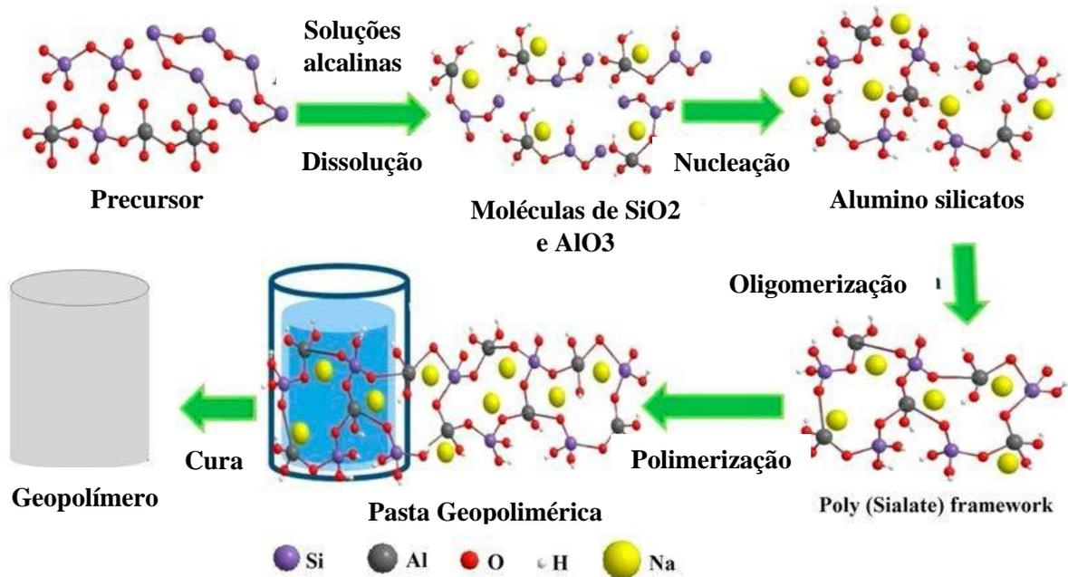
Figura 2: Esquema de geopolimerização, (Zhuang, 2016), (adaptado).
