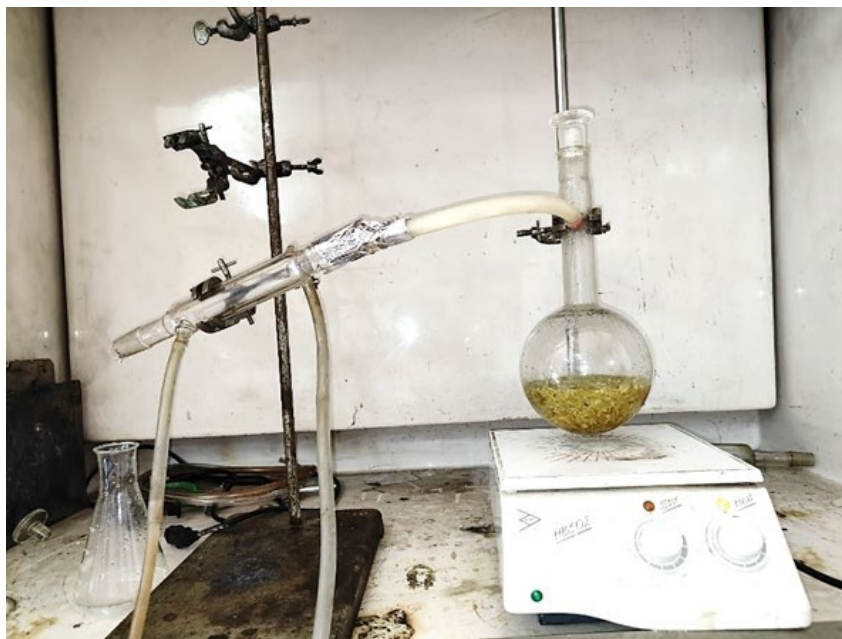
Figura 15: Ensaio laboratorial do processo de destilação.
