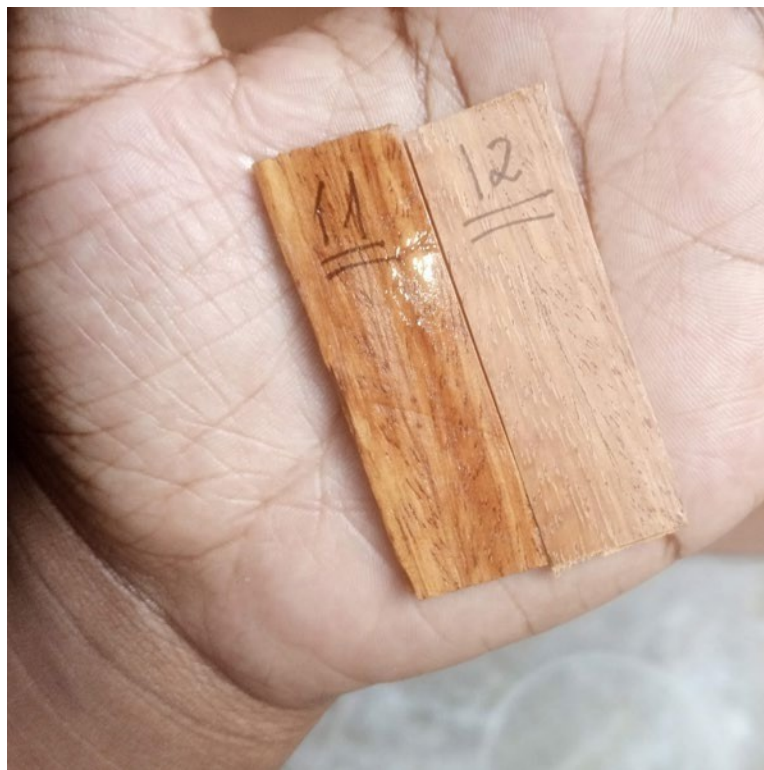
Figura 18: Aplicação do verniz em madeira.
