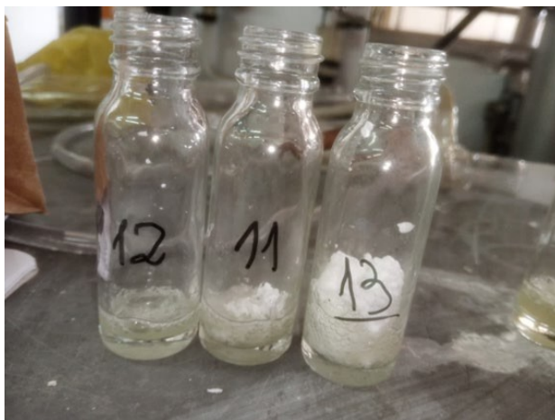
Figura 22: Imagem ilustrativa da dissolução do EPS no D-Limoneno com 2, 1 e 3 ml.
